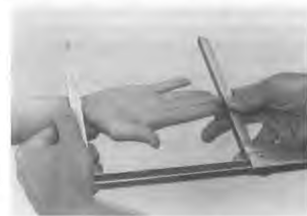
Figura 22 Posizionamento del calibro a scorrimento per la misurazione della lunghezza della mano
