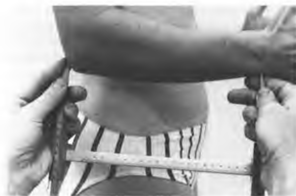
Figura 21 Posizionamento del calibro a scorrimento per la misurazione della lunghezza gomito-polso
